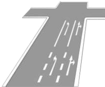
Richtungspfeile (Z 297) verpflichten vor Kreuzungen oder Einmündungen den Fahrverkehr zur Einordnung nach Fahrtrichtung. Vom Fußpunkt des ersten Pfeils in Fahrtrichtung bis zur Spitze des letzten Pfeils vor der Kreuzung oder Einmündung ist das Halten und Parken verboten.
